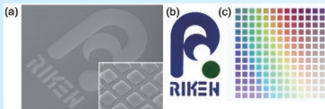
図1: サブ波長アルミニウム構造によるメタマテリアル光吸収体を用いた「色」
